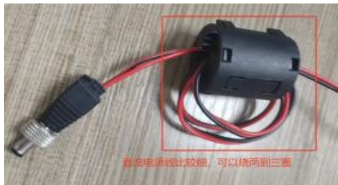
图一：直流供电的插头处增加磁环，靠近主机插头处，电源线径较细，建议缠绕 2-3 圈，共模抑制效果更好，同时固定磁环位置；
